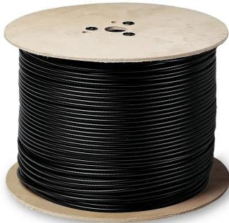
Cable de red exterior CAT 6 con revestimiento de PE negro, rollo de 500 metros compuesto por 4 pares balanceados de 100 ohmios con conductores de cobre rojo flexibles AWG 24. Sus características cumplen con los requisitos de la Cat. 6 Clase E hasta 250 MHz, según las normas ANSI/TIA 568.2-D e ISO/IEC 11801. Apto para aplicaciones Gigabit Ethernet (IEEE 802.3ab).
